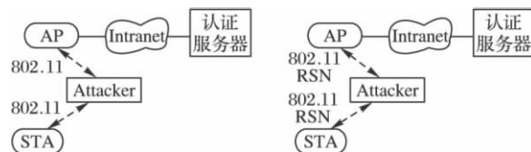
图 2 文献 [5] 的攻击框架 图 3 修正的 RSN 中 MitM 攻击框架
